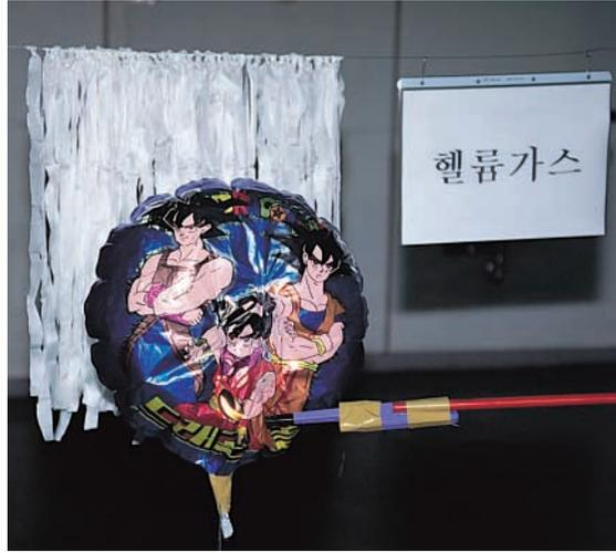
헬륨과 수소가스 풍선의 폭발 여부를 시험한 결과, 헬륨가스 풍선은 폭발하지 않았지만(오른쪽), 수소가스 풍선은 작은 불씨나 전기 스파크에 의해서도 폭발(왼쪽)하므로 화상을 입을 위험이 높다.
